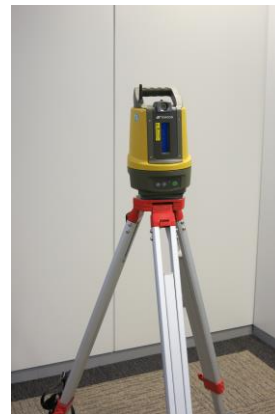
ヘルメット上部にトータルステーション受光部のプリズムを装着（左）し、トータルステーション LN-100 と連携
