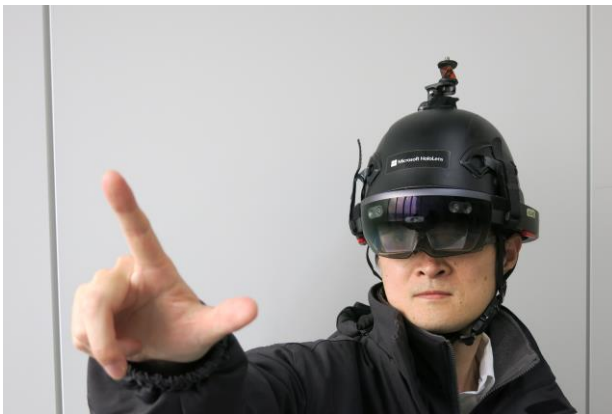
ヘルメット上部にトータルステーション受光部のプリズムを装着（左）し、トータルステーション LN-100 と連携
